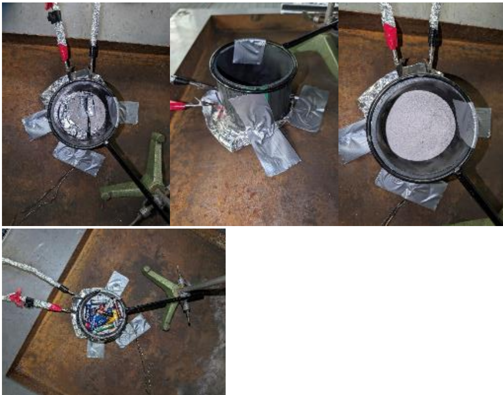
Abbildung 88: Vorbereitung des veränderten Versuchsaufbau mit LiB, Altbatterien und extover®-Granulat
