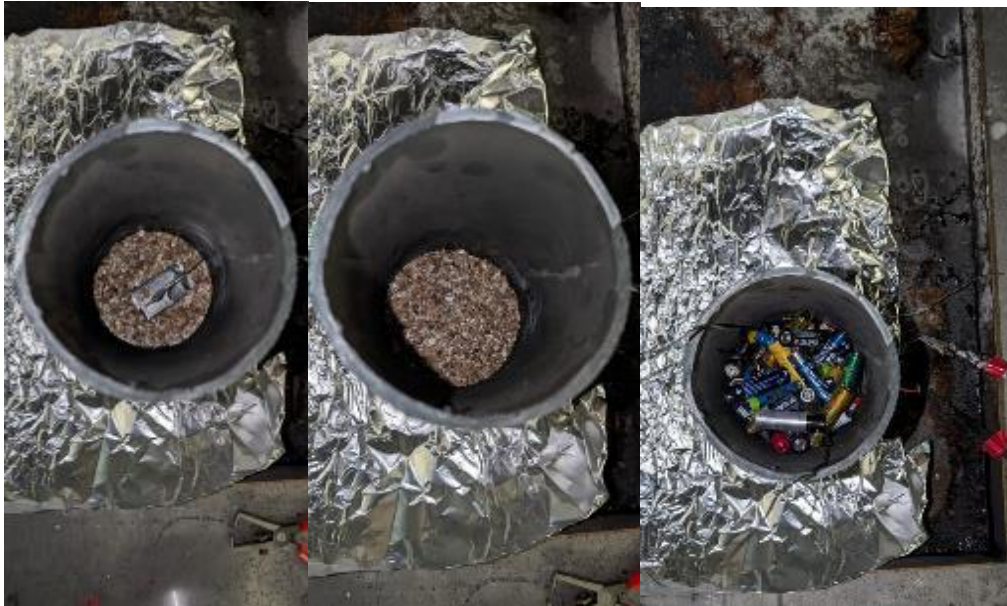
Abbildung 67: schrittweiser Aufbau des Experiments mit Vermiculit, LiB und Altbatterien als Schüttung
