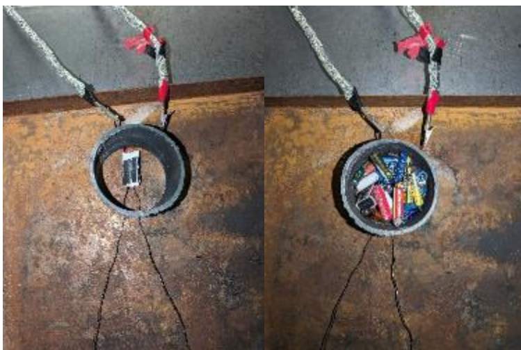
Abbildung 71: Versuchsvorbereitung mit dem verkürzten Dummy, links LiB, rechts mit Altbatterieschüttung
