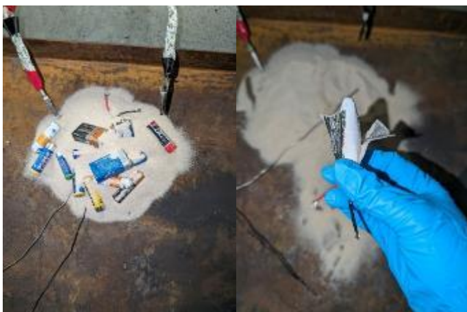
Abbildung 85: Rückstände nach der Zerstörung der LIB
