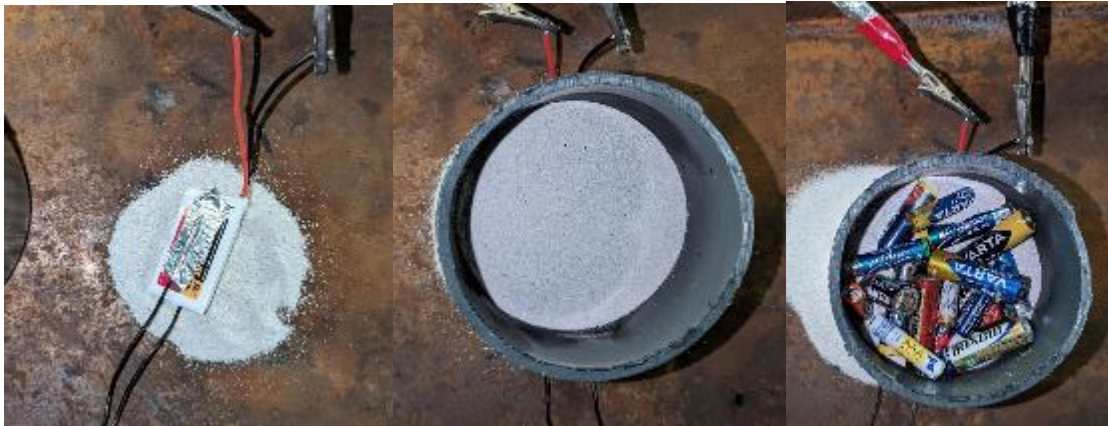
Abbildung 86: Vorbereitung des Experiments mit LiB, Altbatterieschüttung und extover®-Granulat
