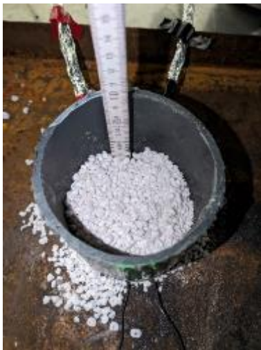
Abbildung 74: Versuch mit Perlit, LiB und Altbatterieschüttung
