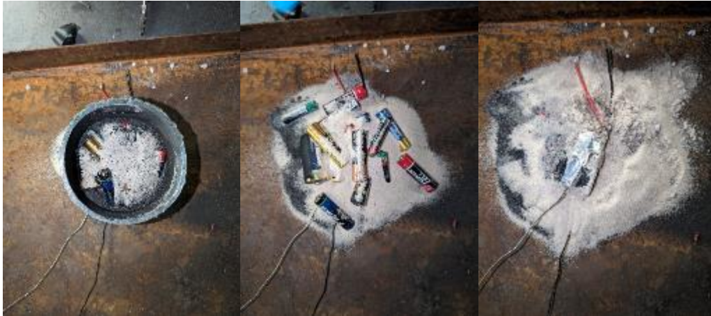
Abbildung 82: Rückstände von Sand, Batterien und LiB nach dem Experiment mit 19 V
