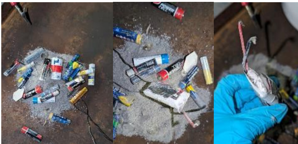
Abbildung 91: Rückstände nach Versuchsdurchführung mit LiB, Altbatterien und Schlacke
