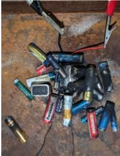
Abbildung 72: Rückstände der LiB und von der Altbatterieschüttung nach dem Versuch
