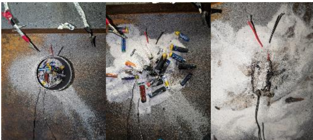
Abbildung 87: Rückstände der LiB, der Altbatterien und des extover® Granulats
