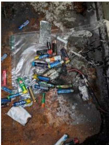
Abbildung 66: Rückstände der Altbatterien, der LIB sowie des PE-Beutels nach dem Versuch
