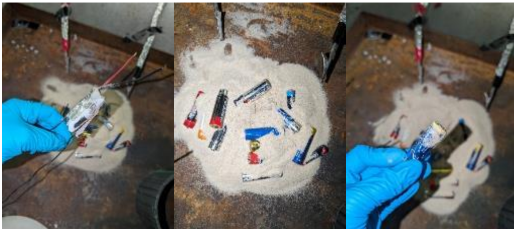
Abbildung 79: LIB nach dem Versuch mit Sand
