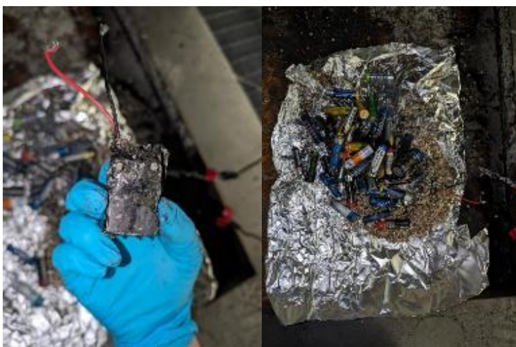
Abbildung 68: Rückstand der LiB (Links) und Rückstände von Vermiculit und Altbatterieschüttung (rechts)
