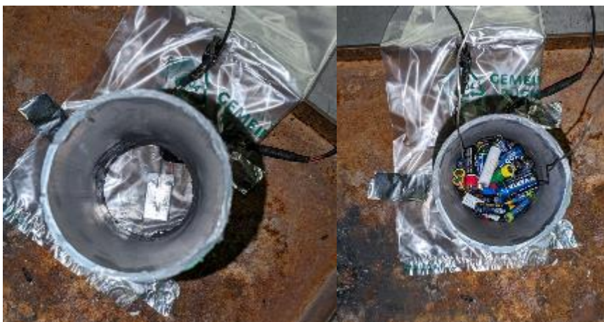
Abbildung 65: Anordnung der LiB mit PE-Folie und Altbatterieschüttung vor dem Versuch
