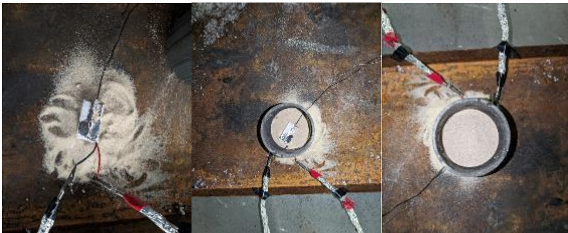
Abbildung 76: Vorbereitung des Versuchs mit LIB in Löschsandschüttung
