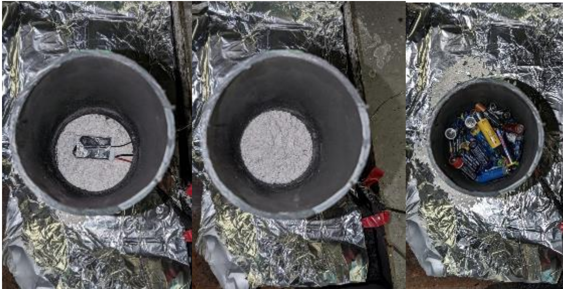
Abbildung 69: Perlit als Bindemittel mit LiB (links und mittig) und einer Altbatterieschüttung (rechts)
