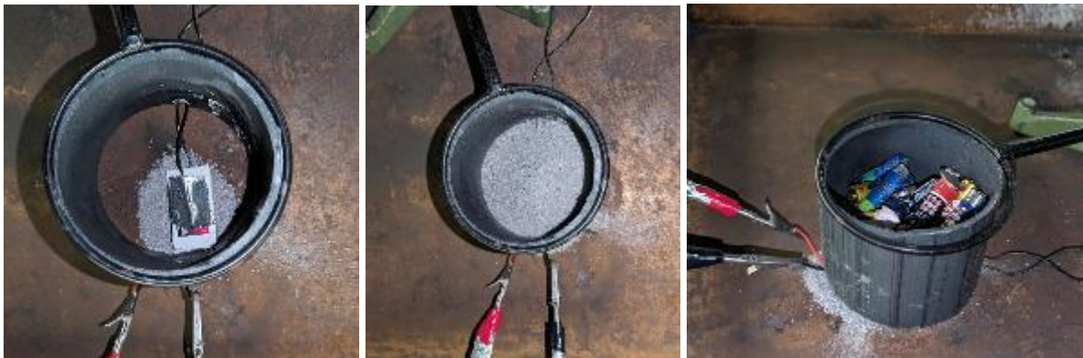
Abbildung 89: Vorbereitung des Versuchs mit LIB, Altbatterien und Schlacke
