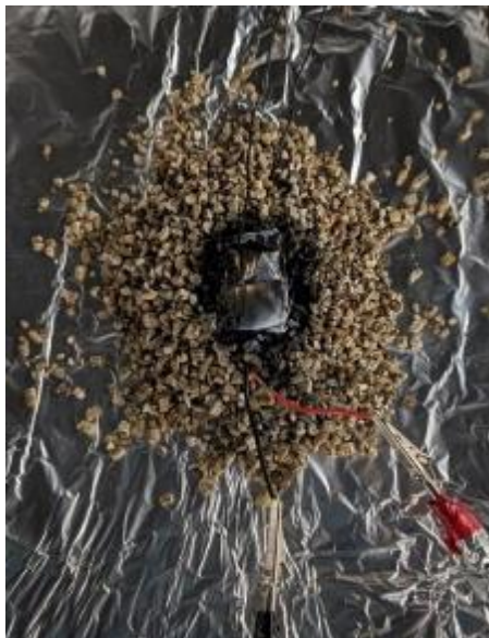
Abbildung 70: Rückstand der LIB und des Perlits nach dem Versuch
