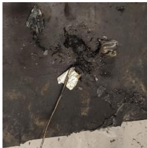
Abbildung 63: LiB in Plastikfolie (nach Versuch)
