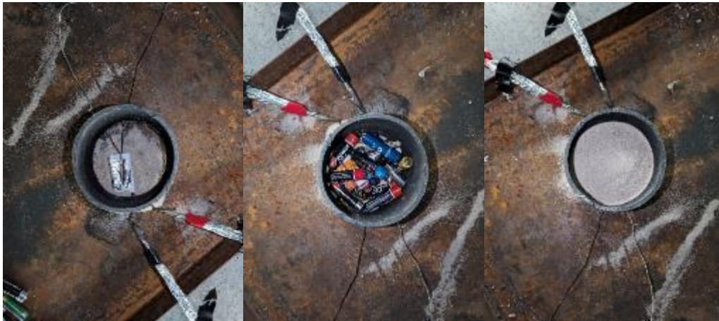
Abbildung 80: Vorbereitung des Versuchs mit LiB, Altbatterieschüttung und Sand
