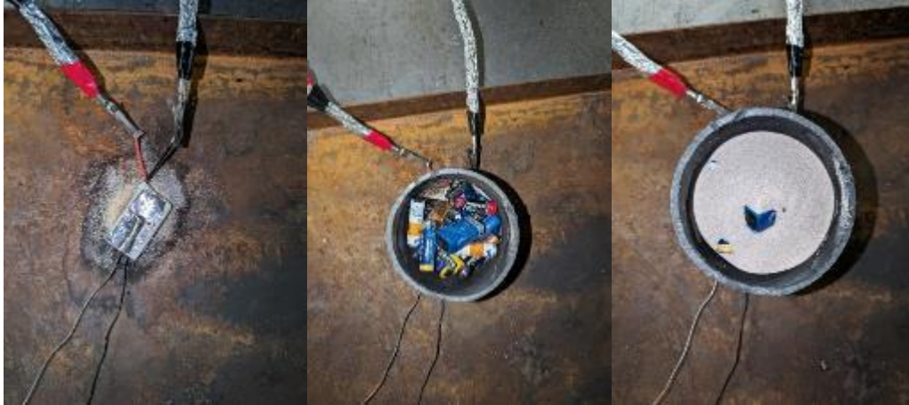
Abbildung 84: Vorbereitung des Experiments mit LiB, Altbatterieschüttung und Sand
