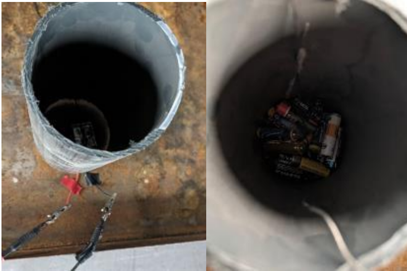
Abbildung 64: Referenzversuch mit LiB unter Altbatterieschüttung ohne weitere Materialien
